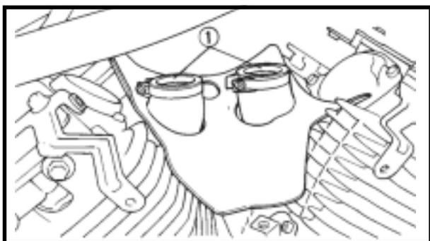
**INSPEÇÃO DOS COLETORES DO CARBURADOR**
